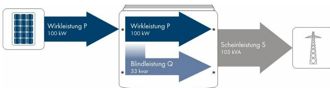
Abb. 5: Die gewünschte Blindleistung wird im Wechselrichter erzeugt – zusätzlich zur aufgenommenen PV-Wirkleistung. Die geometrische Summe aus beiden ist die Scheinleistung, sie ist für die Auslegung des Wechselrichters maßgeblich.
